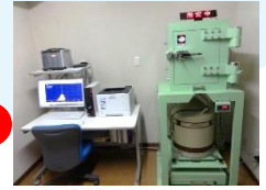
Detector gekoeld door vloeibaar stikstof
